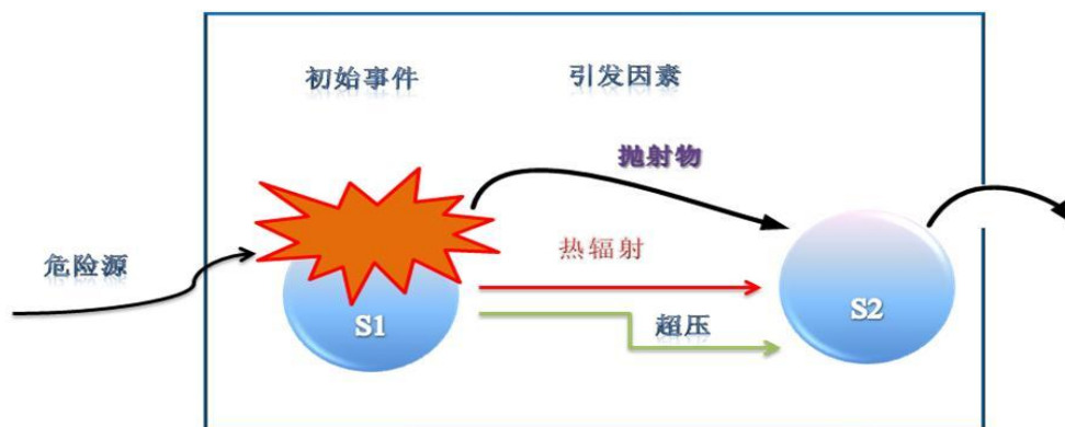
图 4.11-1 多米诺效应系统图
